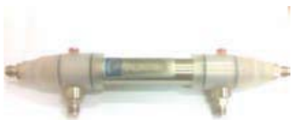
รูปที่ 2 รูปถ่ายแสดงเครื่องทำความชื้นแบบนาฟเพียนเมมเบรน (NMH) จาก Perma Pure ที่ใช้ในการทดสอบ
