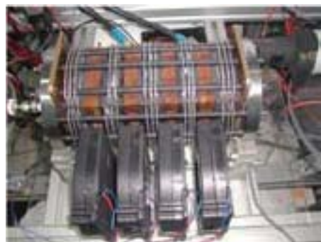
รูปที่ 6 ภาพถ่ายห่อเซลล์เชื้อเพลิงขนาด 300 วัตต์
