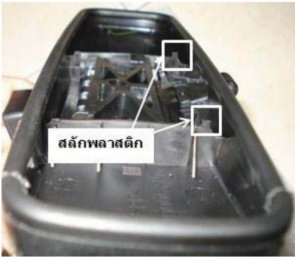
รูปที่ 10 สลักพลาสติกที่เพิ่มขึ้นมาทดแทนก้อนโฟมยาง EPDM
